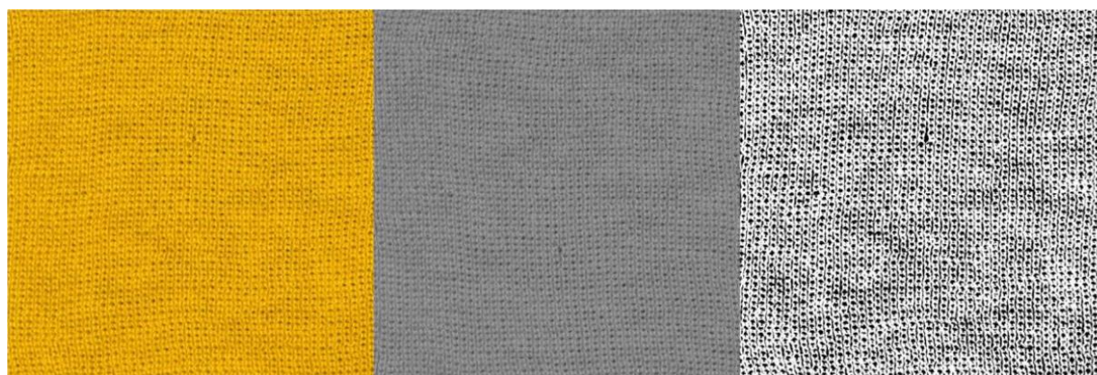
Figure 39: Différents stades du traitement d'image utilisé pour évaluer le facteur de couverture des tricotés
